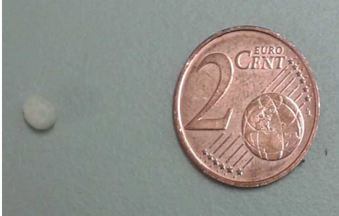
Fig. 25: Single round styrofoam element – a common item in the samples Abb. 25: Einzelne runde Styroporkügelchen – häufiges Stück in den Proben
